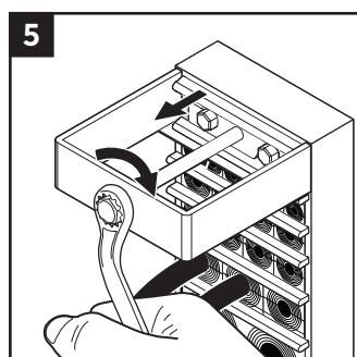
Serrez l'écrou de l'extracteur pour retirer l'unité de compression.
