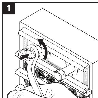
Tournez les boulons dans le sens inverse des aiguilles d'une montre pour relâcher la compression. Assurez-vous de laisser environ 6 mm entre l'unité de compression et les têtes de boulons pour laisser de la place pour le crochet de l'extracteur.
