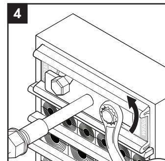
Placez le crochet derrière les têtes de boulons. Tournez les boulons dans le sens inverse des aiguilles d'une montre pour fixer le crochet de l'extracteur d'unité de compression derrière les têtes de boulons.
