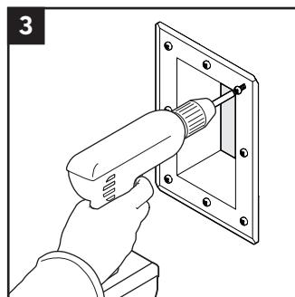
Montieren Sie den GE-Rahmen mit geeigneten Befestigungsmitteln an der Wand.
