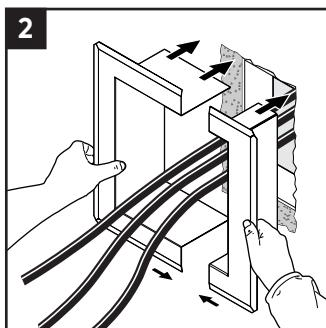
Verwenden Sie einen aufklappbaren GE-Rahmen für bereits verlegte Kabel.
