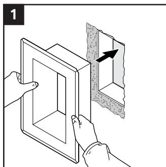
Setzen Sie den GE-Rahmen von hinten in die Durchführung ein.
