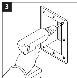
Fixez le cadre GE au mur avec des fixations appropriées.
