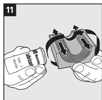
Lubrifiez les surfaces d'étanchéité des modules.
