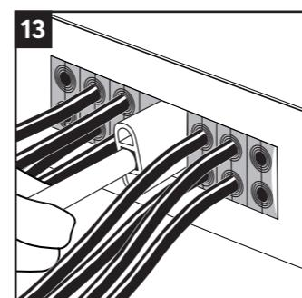
L'utilisation d'un outil de pré-compression Roxtec simplifiera l'installation.
