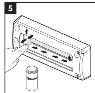
Nettoyez et lubrifiez les surfaces d'étanchéité du cadre avec du lubrifiant Roxtec, en particulier dans les coins.
