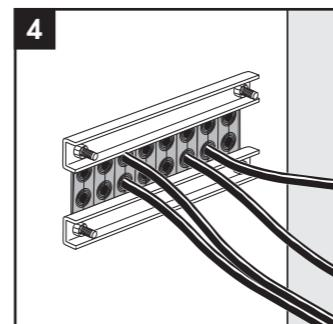
Pour le modèle EzEntry 16, utilisez le contre-cadre (article n° 2CV0000000016) si l'épaisseur de la structure est inférieure ou égale à 2 mm.
