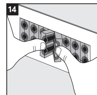
Pour simplifier l'insertion du dernier module, inclinez les moitiés de module et enfoncez-les simultanément dans le cadre.
