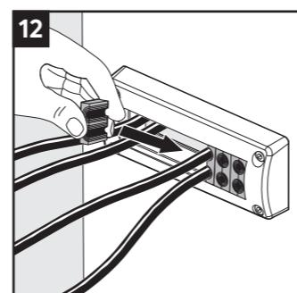
Insérez les modules conformément au plan de remplissage.
