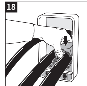
18 继续填满框架的密封空间，如有可能，先安装尺寸最大的电缆。
