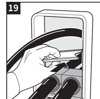
19 每安装完一排模块后，都在上方插入一块隔层板。
