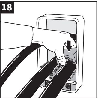
可能であれば、最大径のケーブルから順に、フレームのパッキングスペースを埋めていきます。
